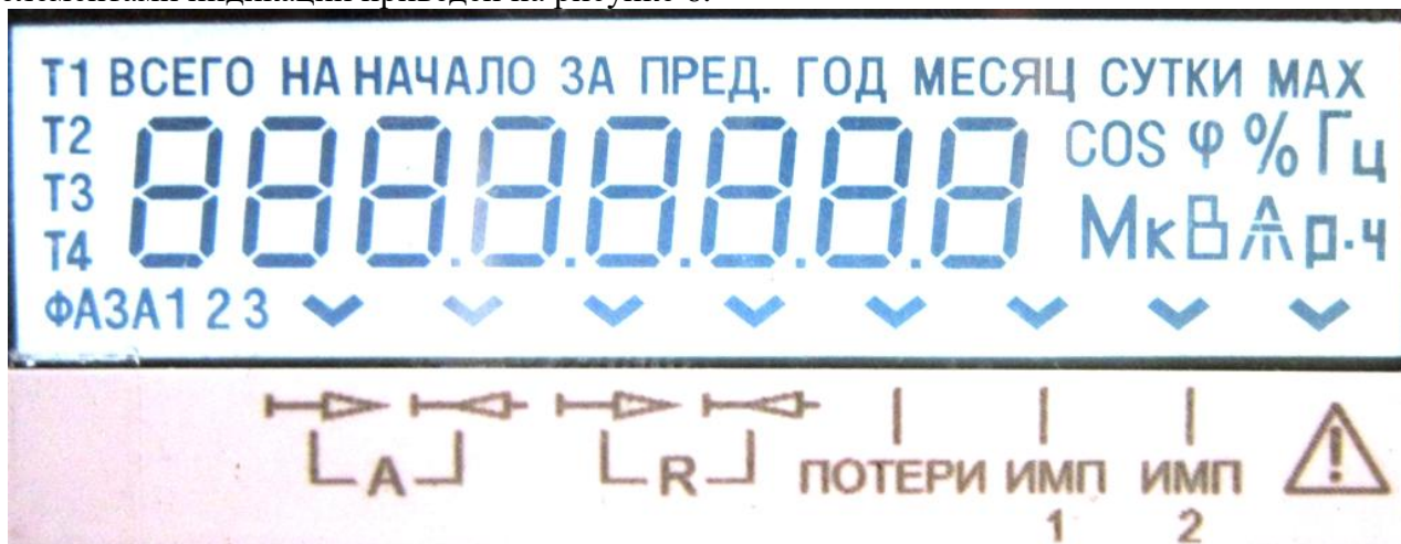
Рисунок 6 – Внешний вид ЖКИ терминала счетчиков наружной установки с включенными элементами индикации
