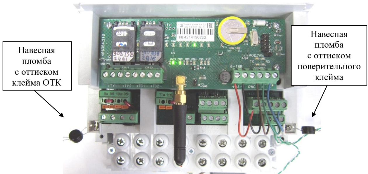
Рисунок 2 - Внешний вид счетчика ПСЧ-4ТМ.05МНТ внутренней установки со снятой крышкой зажимов
